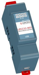
LRS232-802インターフェースは2つのRS-232シリアルポートによってLOYTECデバイスを拡張します。デバイスのUSBポートに接続され、Modbus ASCIIまたはスクリプトモジュールによって実装されたカスタムシリアルプロトコルを実行するように構成できます。(スクリプトにはL-IoT1ライセンスが必要です。) LRS232-802は互換性のあるLINXオートメーションサーバー、L-ROCルームコントローラー、L-IOB I/Oコントローラー、L-DALIコントローラー、L-GATEユニバーサルゲートウェイ、及びほとんどのL-VISタッチパネルで使用できます。USB BUSインターフェースによりデバイスは電源を必要とせず、接続は自動的に検出されます。
