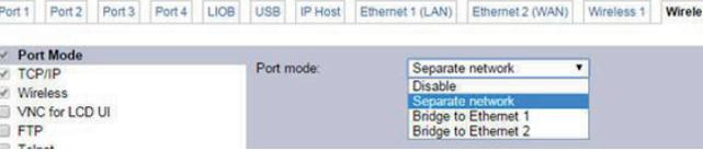
**11** Die drahtlose Schnittstelle 1 + 2 kann von der Ethernet-Schnittstelle getrennt oder zu einem der beiden Ethernet-Anschlüsse verbunden werden.
