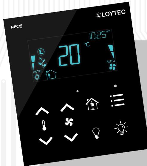
Die internen Sensoren des L-STAT Geräts messen Temperatur, Feuchtigkeit, Kondensationspunkt, Raumbeleuchtung, Anwesenheit sowie den CO<sub>2</sub>-Level. Die Sensorwerte können entweder in SI oder US-Einheiten dargestellt werden. Darüber hinaus werden am LCD
