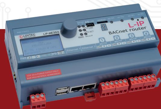
Der neue LIP-ME204 Router ist ein echter Multi-Port MS/TP Router mit 2 Ethernet-Ports und 4 MS/TP Ports. Das Gehäuse ist 159 mm breit und für eine Hutschienenmontage gemäß DIN 43 880 geeignet. Das Gerät verfügt über ein LCD-Display mit Dreh-/Drückrad zur einfachen Geräteinstallation.
