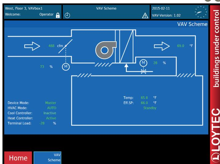
Grafische Visualisierung: Start-Bildschirm VAV-Status (Abb.6), Temperaturtrend (Abb.7), VAV-Schema (Abb.8)
