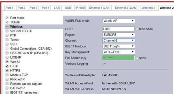
**07** Web Interface zur Konfiguration im Access Point Mode
