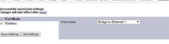
**13** Im bridged Modus werden Protokolle die am Ethernet 1 Anschluss aktiviert sind, automatisch auch auf der drahtlosen Schnittstelle aktiviert.
